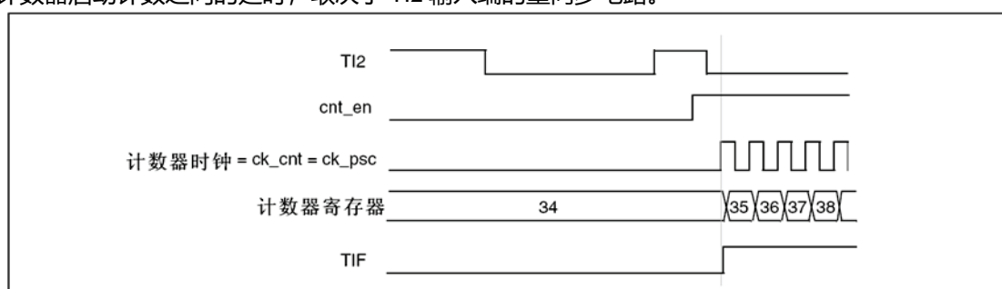
图 94 触发器模式下的控制电路
